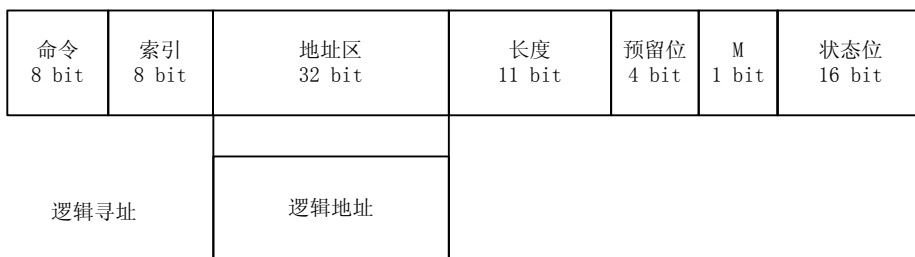
EtherCAT 逻辑寻址结构
