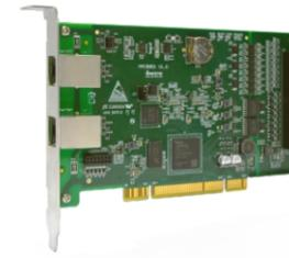
i6系列PC\_Based式EtherCAT总线运动控制器,能帮助机器控制软件的开发人员在原有高级语言开发环境下的快速继承,便于数控自动化设备在多轴、多I/O应用方向的拓展,特别适合原运动控制轴卡为上位方案的技术升级。
