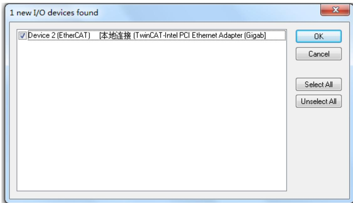
6、如果这个界面弹出，但前面的单选框没有打勾，则是网卡没有安装好。在 TwinCAT-Show realtime ethercat compatible devices...下面进行安装
