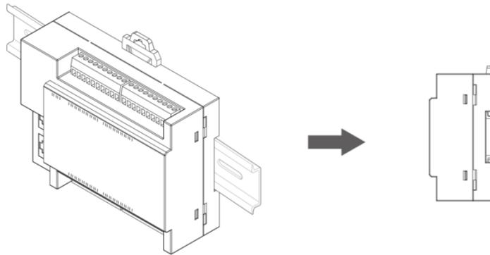
4、推入 DIN 导轨安装挂钩锁定。
