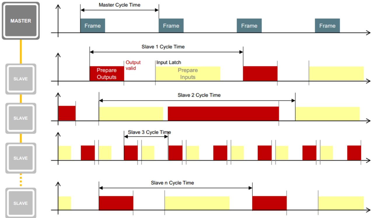
图10. Free-Run模式：不同的E系列单元同一个通信周期的刷新
