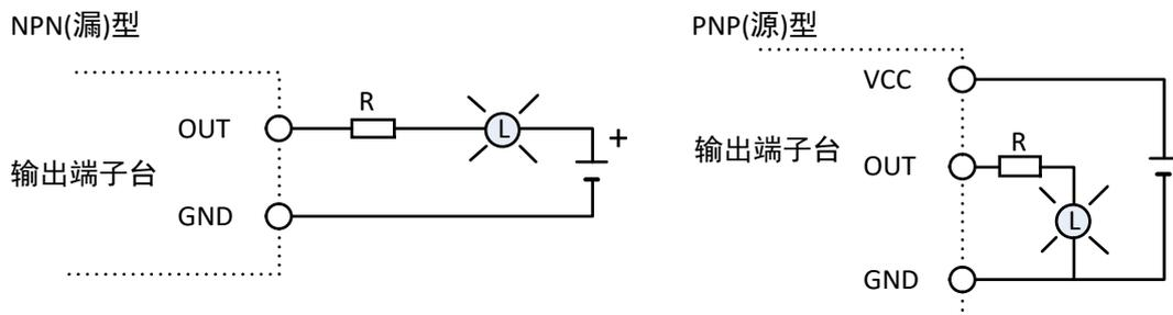
方法一中，向负载 L 供给的电压未下降，I/O 电源的消耗电流增大。
