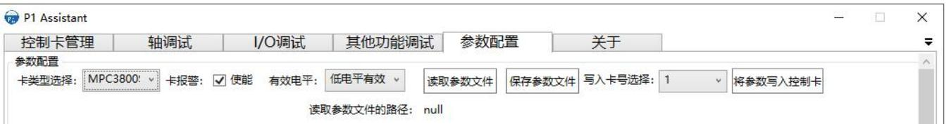
在“参数配置”界面，可对伺服/步进轴的参数，设备的轴 I/O 参数，用户自定义 I/O 参数等进行设置。设置完毕后可将该参数保存为文件或者直接写入到控制卡内。该界面中所有的参数均可以通过 P1 系列的 SDK 提供的函数进行设置。每项参数的详细说明，请参考《编程手册-P1 系列运动控制卡》。保存的参数文件也可通过专用函数读取并设置参数。
