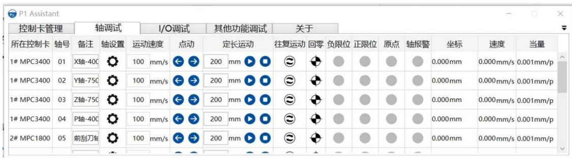
P1 控制卡中的 I/O 编号由用户自定义排序，其编号为“卡号.I/O 编号”。在设备电气调试时可通过 P1 Assistant 中的“I/O 调试页面”中的“备注”标注 I/O 名称或使用信息。如 1#卡上的第 8 位自定义 DI 为轨道顶升到位，可在备注中标识“到位顶升”。
